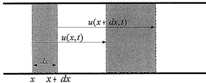
FIG. 2 – Schéma d'une tranche de fluide située initialement entre les abscisses  $x$  et  $x + dx$ . Le fluide est contenu dans un tuyau de section droite  $S$ . Les particules qui étaient au repos en  $x$  se trouvent au passage de l'onde en  $x + u(x, t)$ .
