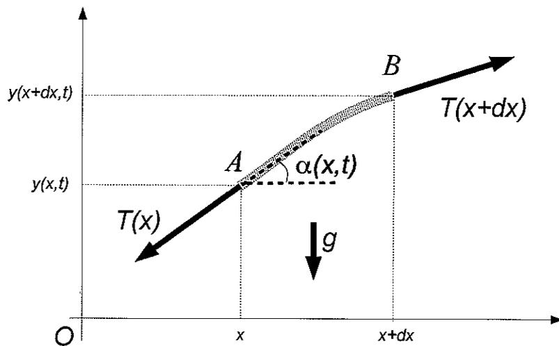
FIG. 1 – Schéma d'un élément de corde situé entre les abscisses  $x$  et  $x+dx$ . La tension interne de la corde au point  $x$  à l'instant  $t$  est notée  $\mathbf{T}(x)$  et s'exerce tangentiellement à l'élément de corde. On note  $\alpha(x, t)$  l'angle algébrique formé par la tangente à la corde et l'horizontale au point  $x$ .
