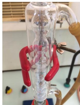
4. Une fois le montage en place, faire circuler l'eau dans le réfrigérant et ajouter le dispositif chauffant agitant, en veillant à le surélever pour pouvoir le baisser facilement en cas de surchauffe.
