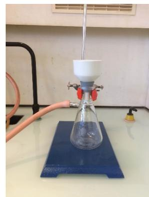
2. Connecter le tuyau de la pompe à vide ou trompe à eau, avec l'aspiration coupée.
