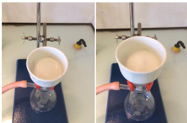
3. Introduire un papier filtre dans l'entonnoir Büchner. Humidifier le papier filtre à l'aide du solvant utilisé lors de la filtration.
