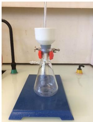
1. Fixer la fiole à vide fermement, à l'aide d'une pince à 2 ou 3 doigts. Ajuster l'entonnoir Büchner à la fiole à l'aide d'un joint en caoutchouc pour assurer l'étanchéité.
